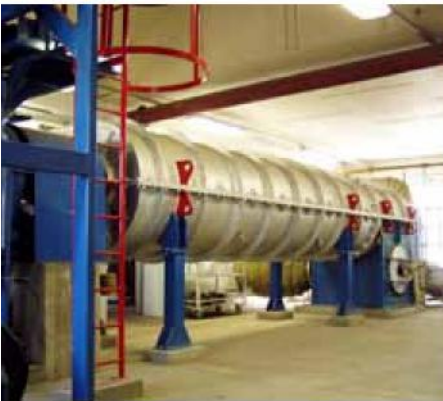
Foto: 3R emissievrije unit voor productie van biochar, door Edward Someus
