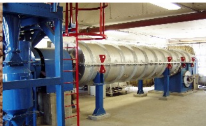
Bioszén előállítására használt 3R zéro emissziós berendezés
