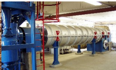
3R Unidad de producción de biochar de emisión cero
